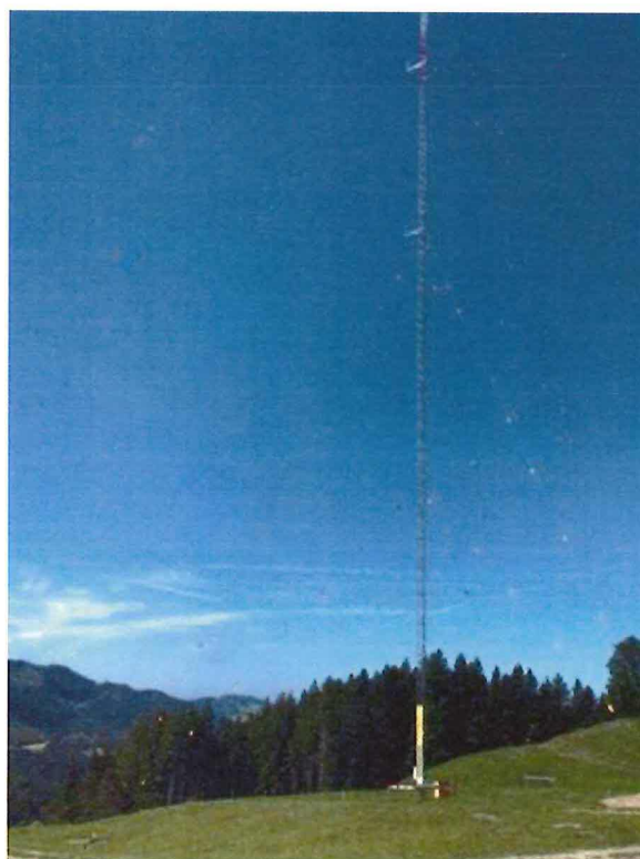
Abbildung 3: SpiDAR Wind LIDAR, temporäre Windmessungen Oberfeld, (Sept-Nov. 2014) und 100 m Windmessmast Juli 2015 bis August 2016
