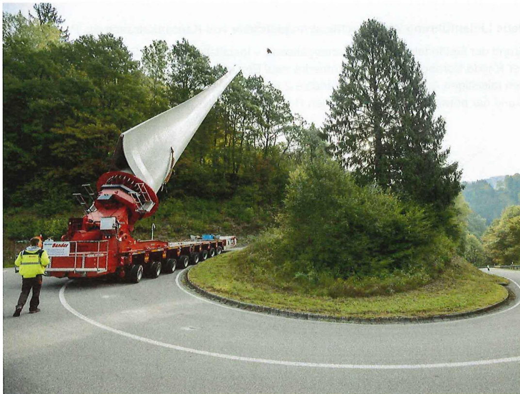
Abbildung 23: Transport Rotor im Wald mit Selbstfahrer
